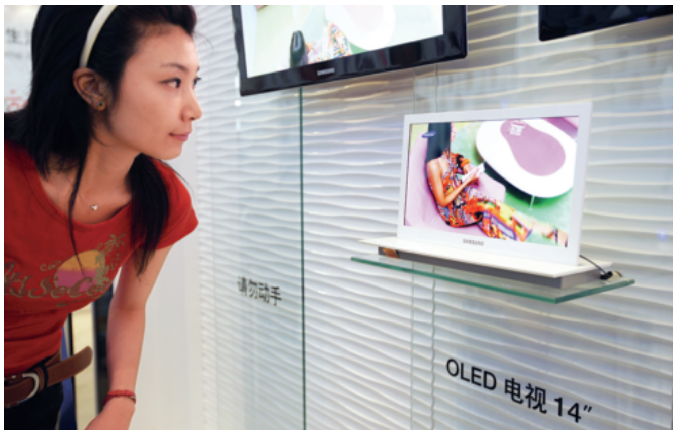
OLED是Active Matrix Organic Light-Emitting Diode的缩写，指与通过白光发光的液晶显示器不同，可自身发光的显示器。它的影像反映速度比薄膜晶体管液晶显示器（TFTLCD）高出1000倍以上，且色彩表现能力和对比度也更加优越，因此是最好的动态显示器。图为北京科技博览会上展出的新产品OLED电视。
