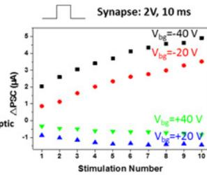
石墨烯类突触器件的结构和测试结果，通过背栅电压的调制可调制类突触器件的可塑性
